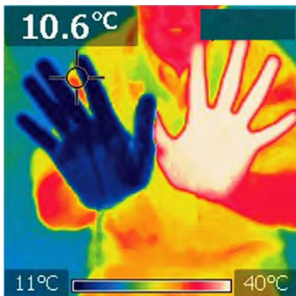
شکل ۶. تصویر IR به دنبال غوطه‌ور شدن دستان در آب سرد (چپ) و گرم (راست) گرفته می‌شود.
