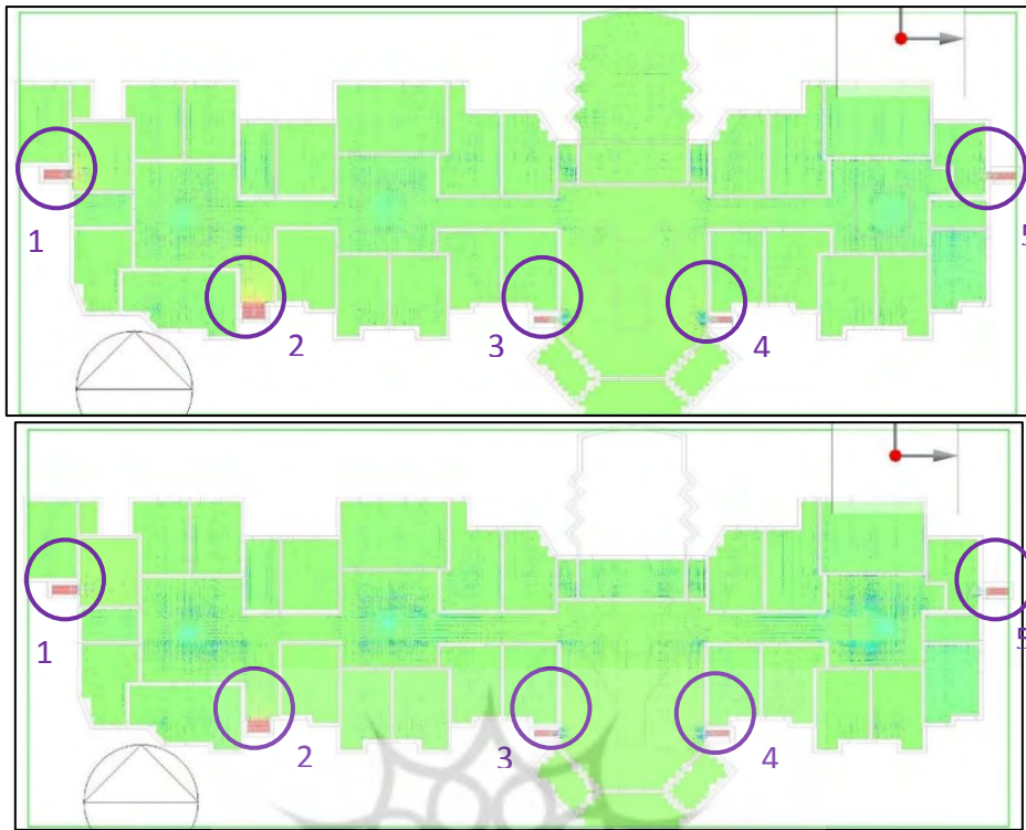
تصاویر ۱۶ و ۱۷. توزیع دمایی طبقات همکف و اول ساختمان با اعمال دودکش خورشیدی با روش دینامیک سیالات (CFD)
