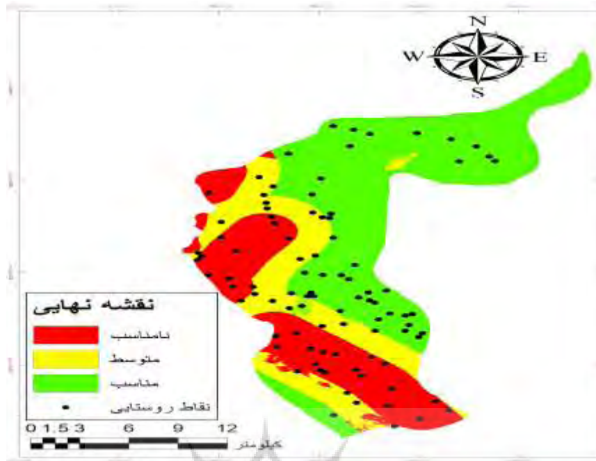
شکل ۳- نقشه نهایی (ترکیبی از تمام متغیرها) مورد استفاده برای پهنه بندی زلزله
