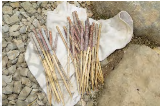
تصویر ۱۳. شیش (سوزن‌های اتصال چوبی) (نگارنده)
