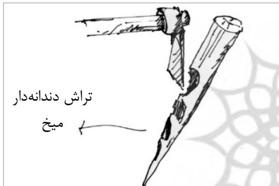
تصویر ۱۴. تراش دندان‌دار میخ (نگارنده)
