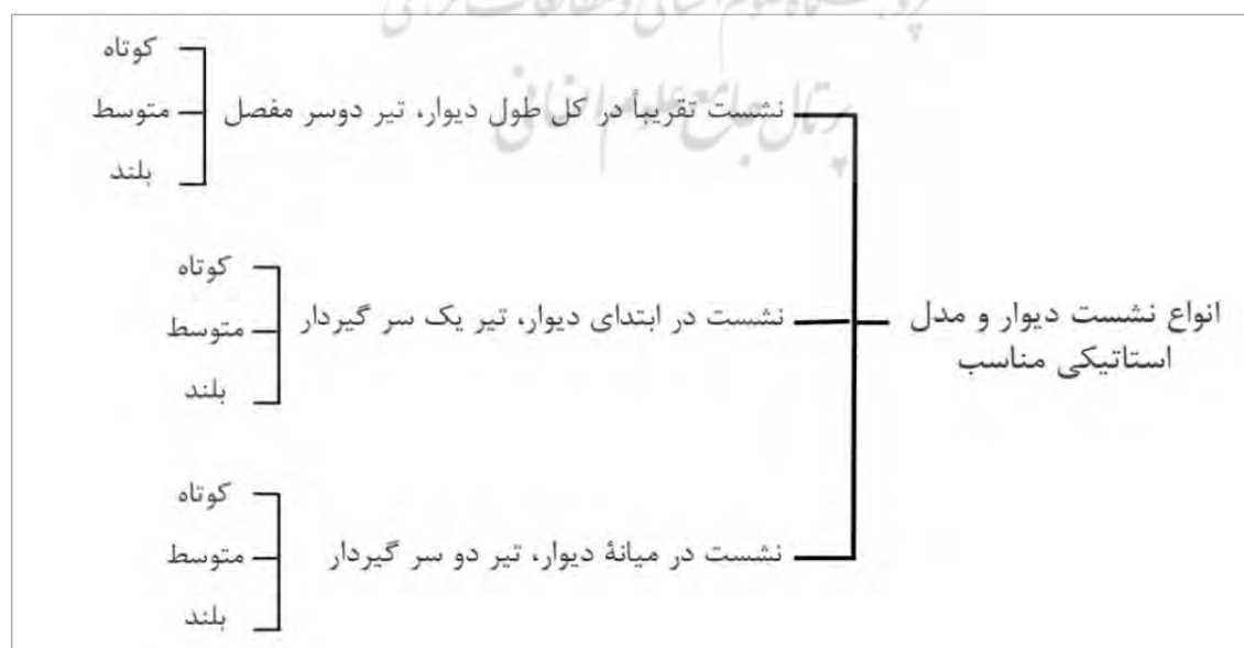
نمودار ۱. انواع نشست دیوار و مدل استاتیکی مناسب (نگارندگان)
