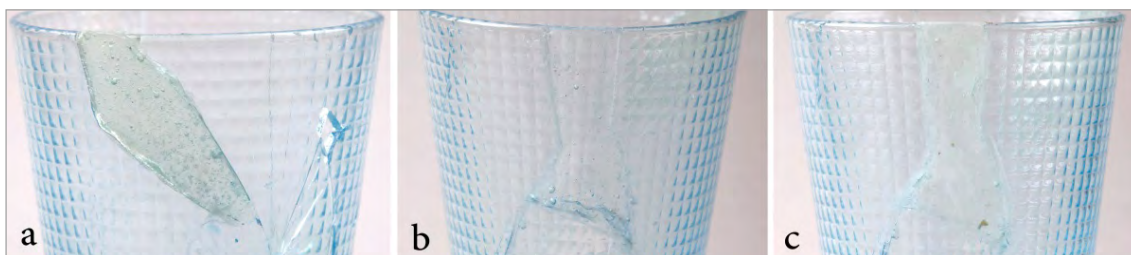
تصویر ۲. بازسازی لیوان مات به روش معمول با پرکننده اپوکسی به ترتیب با قالب‌های: a، طلق و اپوکسی همراه با دانه‌های شیشه‌ای. b، سیلیکون رابر. c، آلجینات (نگارندگان)
