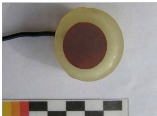
تصویر ۳. تفاوت در رنگ کوپریت قبل از غوطه‌وری در سیتریک اسید به مدت یک ساعت (نگارندگان).
