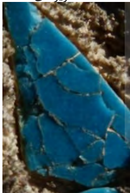
تصویر ۴. وجود ترک شبکه‌ای در سطح لعاب کتیبه (نگارندگان).
