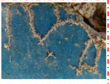
تصویر ۷. تبلور نمک در سطح ترک‌ها (نگارندگان).
