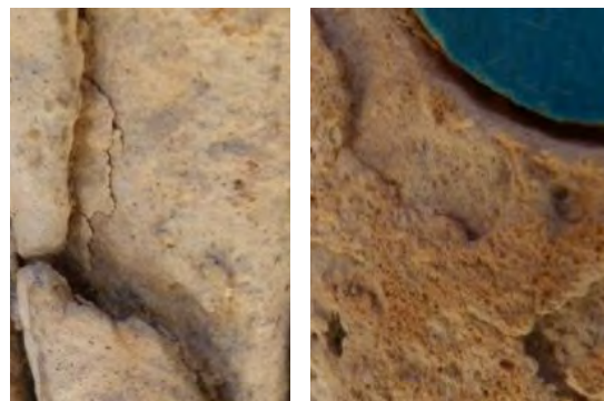
تصویرهای ۱۸-۱۹. پوسیدگی در سطح سنگ کتیبه (نگارندگان).
