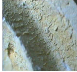
تصویر ۷. بررسی سطح نمونه گچ‌بری برجسته با استفاده از لوپ دیجیتال با بزرگ‌نمایی ۲۰۰ برابر (ردّ ابزار برش در تصویر کاملاً مشهود است)، (نگارندگان).
