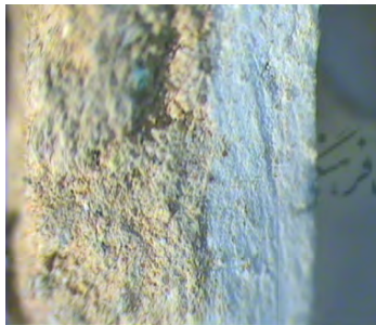
تصویر ۱۲. مقطع عرضی نمونه گچ‌بری لچکی محراب شازده با بزرگ‌نمایی ۱۸ برابر (نگارندگان).
