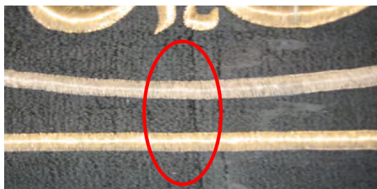
تصاویر ۶. اثرات آسیب و ریختگی پرز پارچه مخمل و پودزدن هنگام بافت (مأخذ: نگارنده)
