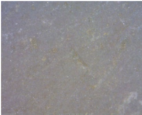
تصویر ۱۴. تصویر میکروسکوپی از سطح سنگ تکیه گاه تزئینات مورد بررسی. تخت مرمر. (بزرگنمایی: X 200)
