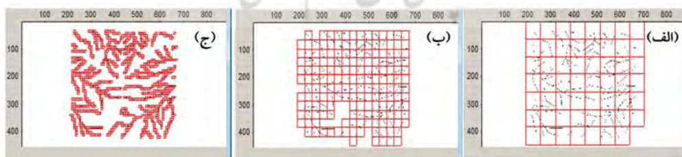
شکل ۶. نحوه محاسبه بعد فراکتال شبکه زهکشی روی سازند کهر، با تغییر مقیاس اندازه جعبه ۸ (الف)؛ اندازه جعبه ۱۶ (ب)؛ اندازه جعبه ۳۲ (ج)
