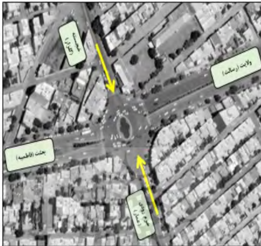
شکل (۳): فاز بندی چراغ‌ها در وضع موجود (شمالی-جنوبی: ۲۰ ثانیه)
