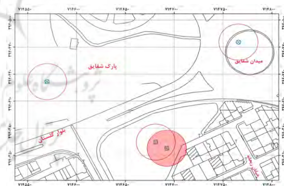
شکل ۵: عدم رعایت حریم مجاز دکل برق در محدوده
