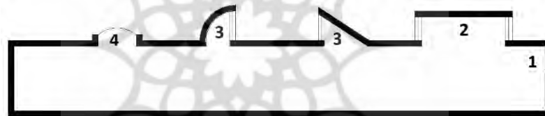
شکل ۱- انواع نورگیر: ۱- زیر سقفی ۲- دوطرفه ۳- یک‌طرفه ۴- افقی یا سقفی (CIBSE, 1999)
