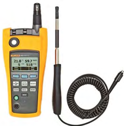
شکل ۲) دستگاه برداشت داده‌های اقلیمی (Fluke AirMeter)
