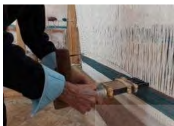
تصویر ۲۸: پنجه زدن بعد از پودگذاری
