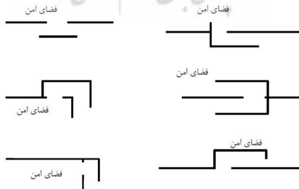
شکل ۲۳_ نمونه هایی از ایجاد انحراف و مانع در مسیر ورودی فضاهای امن، ماخذ: (جهانگیری، ۱۳۹۴)
