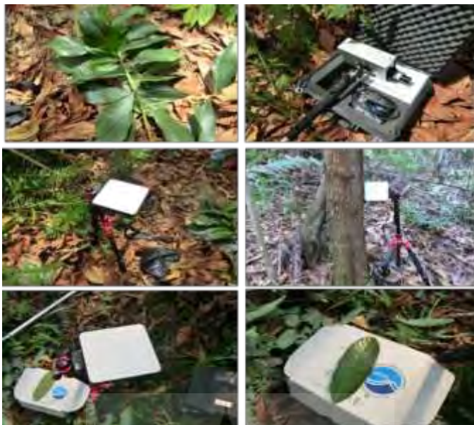
شکل ۴: اندازه‌گیری نمونه‌های بازتاب طیفی پدیده‌های مختلف با استفاده از دستگاه طیف سنج با طول موج ۱۰۵۰ نانومتر
