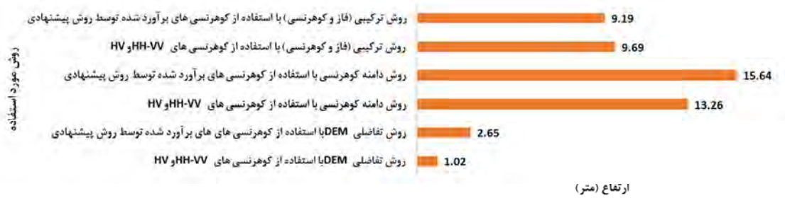
شکل ۸. نتایج برآورد ارتفاع جنگل در باند P در منطقه جنگلی با درختان برگ ریز (ارتفاع واقعی = ۱۸ متر)
