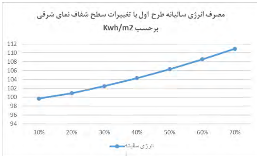
شکل ۵. میزان انرژی کل مصرفی در ساختمان‌های طرح اول دارای ۳۰ درصد سطح شفاف در نمای جنوبی و ۱۰ درصد در نمای شمالی، با تغییر سطح شفاف نمای شرقی
