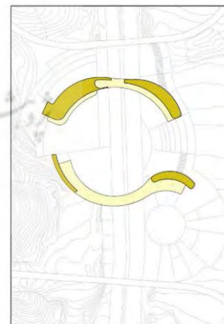
شکل ۱۰) قسمت‌های دو طبقه پل
