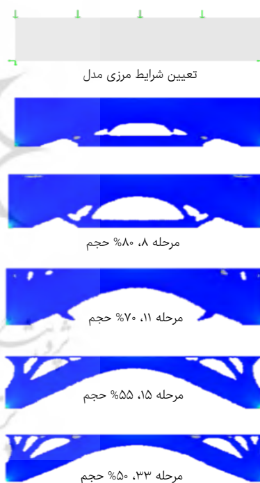
شکل ۲) توزیع مصالح در چرخه‌های بهینه‌سازی توپولوژی در یک پل
