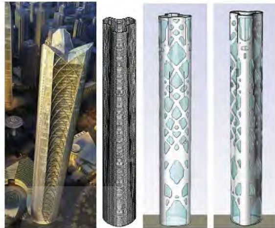
شکل ۵) نمای دیاگراید فرم‌یابی شده به‌وسیله بهینه‌سازی توپولوژی [10]
