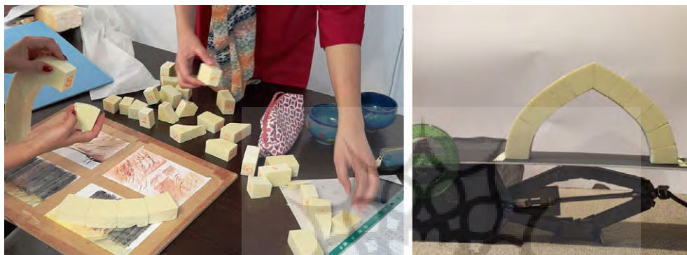
تصویر ۴: قطعه‌های فوم، شماره‌گذاری و بر روی هم چیده می‌شوند. صفحه زمین توسط یک جک به آرامی دوران می‌یابد.
