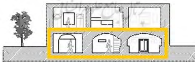
تصویر ۹: موقعیت و ارتفاع سیزان نسبت به کف حیاط در مقطع خانه صمدیان (ماخذ: سازمان میراث فرهنگی استان همدان)
