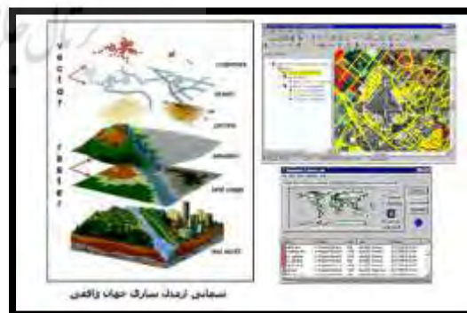
شکل ۱: نمونه ای از لایه های رقومی شده در محیط GIS و بانک اطلاعاتی آنها
