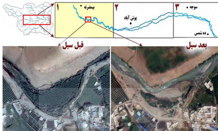
شکل ۴- فرسایش و از بین رفتن درختان در بستر رودخانه بر اثر سیلاب
