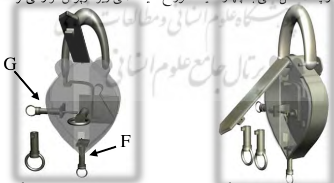
شکل ۷، باز شدن در روی سوراخ کلید اصلی کلید و عقب رانده شدن میله مانع به وسیله دو کلید توپیچ با مکانیزم فنر مارپیچ
