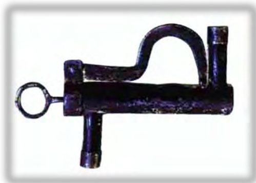
شکل ۱۲، قفل فولادی لوله‌ای با دو مکانیزم فنرخاردار و فنر مارپیچ با ۳ کلید، سده ۱۳ق (تناولی، ص ۱۱۷)
