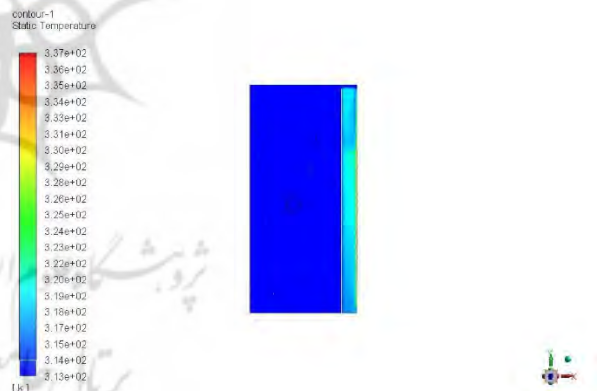
شکل ۱۵) کانتور دما در مقطع عرضی حالت A3 همراه با ابزار سایه‌انداز
