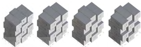
شکل ۳) مدل‌های متخلخل با الگوی توزیع تخلخل دانه‌ای و عمق تراس‌های متفاوت (از چپ به راست: U-RL 1.8, U-RL 1.5, U-RL 1.2, U-RL 0.9)
