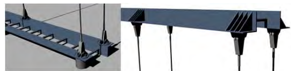
شکل ۹) راست: لچکی‌ها برای تقویت نبشی‌ها در محل اتصال کابل‌ها؛ چپ: استوانه تنظیم‌کننده طول کابل‌ها. (ترسیم: نگارندگان)
