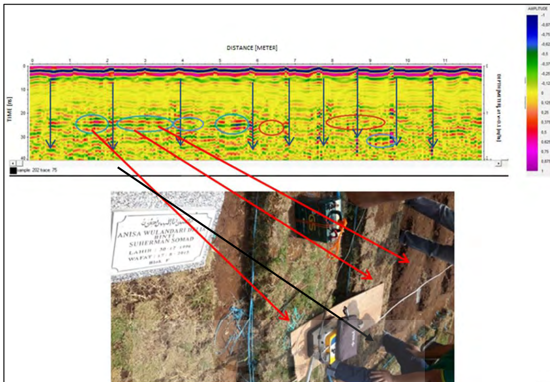
شکل ۱۰: برداشت داده‌های GPR بر روی یک قبرستان قدیمی Fig. 10: GPR data acquisition on the ancient cemetery
