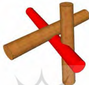
تصویر ۴. شبکه پیوند تیرهای چوبی در کلاف کشی چوبی سازه برج بزرگ جنوبی قلعه رشیدیۀ تبریز و جزئیات اتصال‌های موجود در شبکه تیرهای چوبی کششی آن؛ برگرفته از مشاهدات آندوسکوپیک. مأخذ: نگارندگان (طراحی از امین مرادی).
