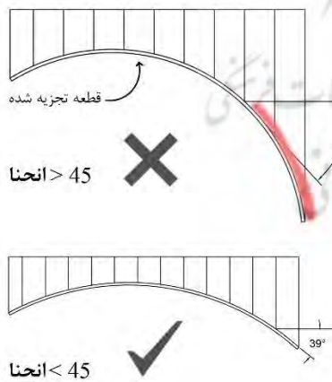
شکل ۱۱. مقطع قطعه با زاویه بیش از ۴۵ درجه و کمتر از
