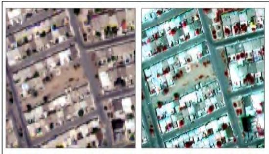
شکل ۵. نمونه ای از سطوح شهری فیوژن شده (تصویر سمت چپ تصویر با قدرت تفکیک ۲ متر و تصویر سمت راست تصویر فیوژن شده با قدرت تفکیک نیم متر را نشان می دهد). (منبع: نگارندگان، ۱۳۹۷)
