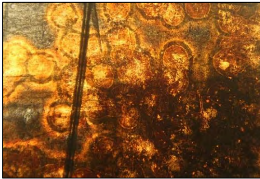
شکل ۱۲: تصویر میکروسکوپ نوری عبوری از نواحی کاملاً تخریب شده در سطح نمونه. بزرگ‌نمایی ۴۰ برابر Fig: 12: Optical microscopy image of complete deterioration on the surface of the sample, 40 x
