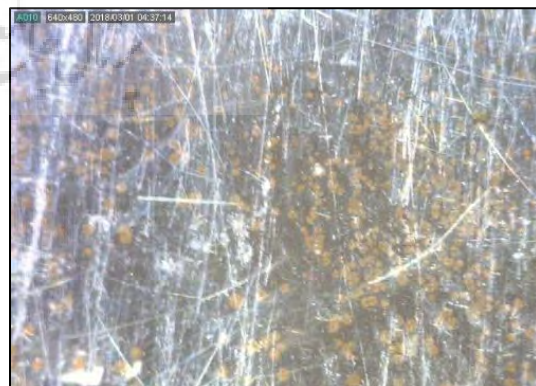
شکل ۱۳: تصویر میکروسکوپی تاول‌های اکسایش- کاهش در سطح نمونه با لوپ دیجیتال. بزرگ‌نمایی ۲۰۰ برابر Fig: 13: Microscopic image of redox blemishes on the surface of the sample by digital loop, 200 x
