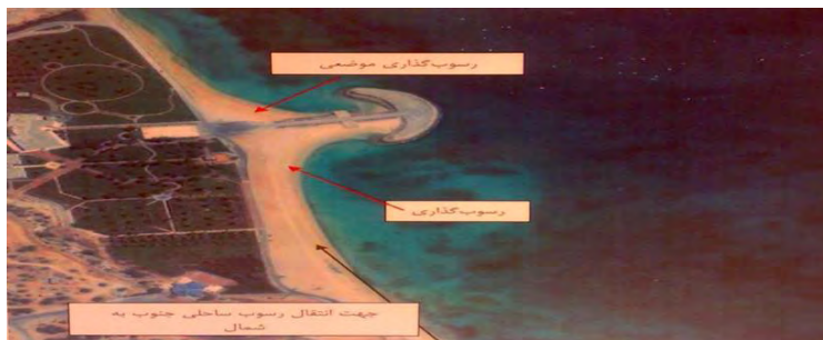
شکل ۸: رسوب گذاری در اطراف اسکله سنگی پاپیون (مأخذ: مهندسین مشاور سازه پرداز، ۱۳۸۶)
