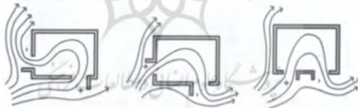
شکل ۱۸- تاثیر دیواره‌های بازشوها و نحوه قرار گیری آن‌ها نسبت به یکدیگر در حرکت جریان
