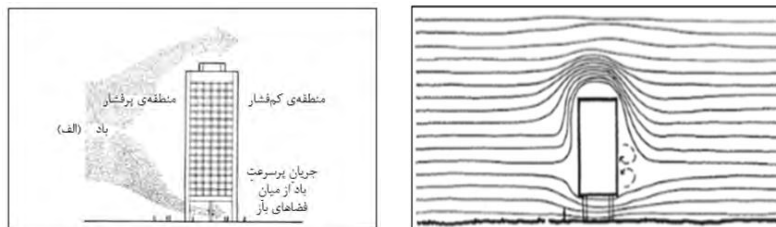
شکل ۲۱- استفاده از فضای خالی در فرم کلی ساختمان به منظور تسریع جریان هوا
