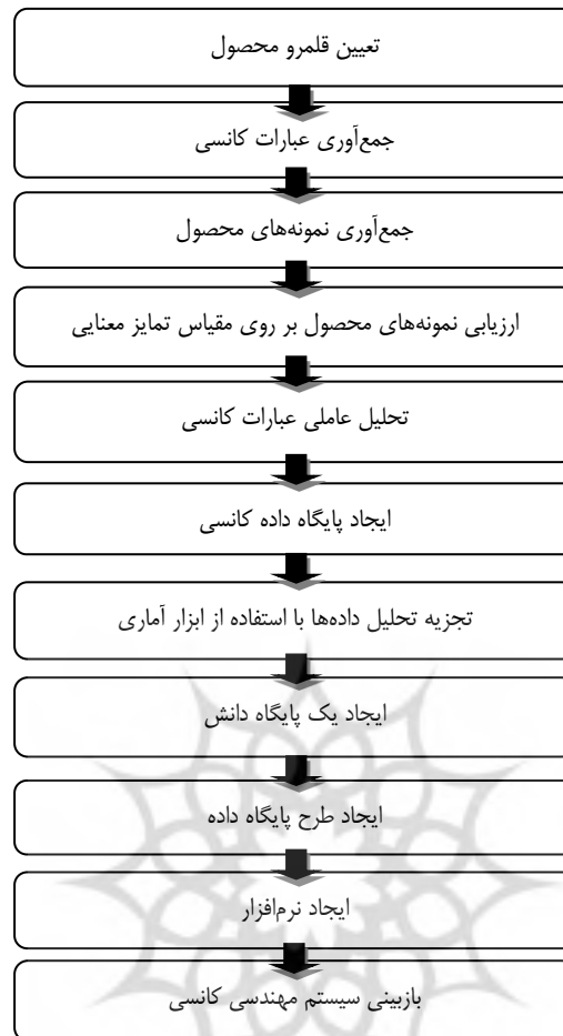
شکل ۲. طرح کلی از روند سیستم مهندسی کانسی [۱۲].
