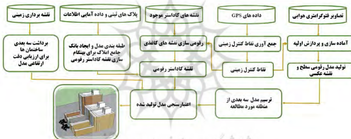
نگاره ۱۰: مدل مفهومی جریان کار تولید مدل سه بعدی کاداستر شهری به روش فتوگرامتری هوایی
