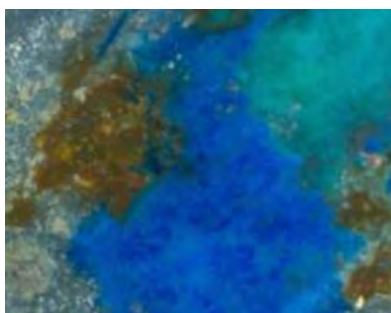
تصویر ۱۱. سنگ معدن مس با بلورهای مالاکیت و آزوریت. بافت قرمز رنگ در سمت چپ تمرکز آهن را اثبات می‌نماید، بزرگ‌نمایی ۱۰×. (نگارنده).
