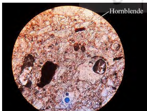
شکل ۲۳: کانی هورنبلند و هوازگی اطراف آن، بزرگنمایی ۱۰۰X حالت XPL Fig: 23: Hornblende mineral and weathering around it, 100x, XPL mode
