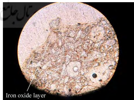
شکل ۱۸: وجود لایه اکسید آهن بر روی ذرات کوارتز، بزرگنمایی 25X حالت PPL Fig: 18: The presence of iron oxide layer on the quartz particles, 25x, PPL mode
