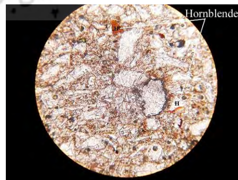
شکل ۲۲: کانی هورنبلند، بزرگنمایی، ۱۰۰X حالت XPL Fig: 22: Hornblende mineral, 100x, XPL mode
