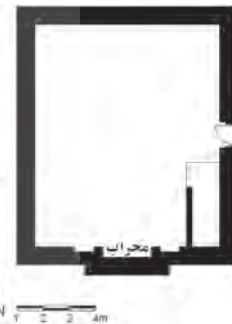
نقشه ۴. پلان طبقه دوم مسجد کوچکه میر نطنز و موقعیت قرار گیری محراب در آن، ماخذ: همان.
