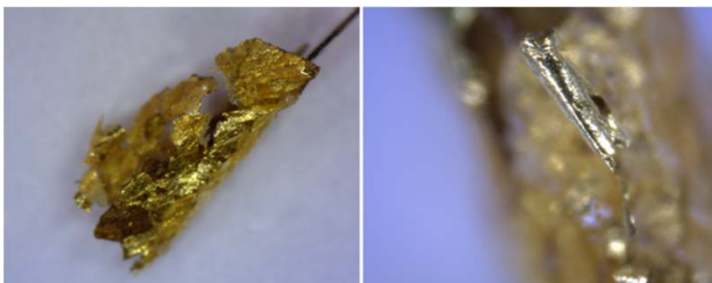
شکل ۴: تصاویر میکروسکوپی از نمونه با بزرگنمایی ۲۰۰ و ۵۰۰ برابر. کاربرد ورق فلزی در این شکل مشهود است. Fig. 4: Microscopic images of sample. Magnification: 200X and 500Xtimes. Use of metal leaf is evident in this figure.
