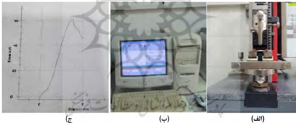
شکل ۲- الف. اندازه‌گیری پارامترهای بیومکانیکی به وسیله آزمون خمشی سه نقطه‌ای؛ ب. ثبت هم‌زمان اطلاعات مربوط به هر نمونه؛ ج. نمونه‌ای از منحنی تنش - کرنش
