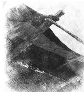
شکل ۶. جزئیات قرارگیری ستون مورب داخل حلقه اتصال
