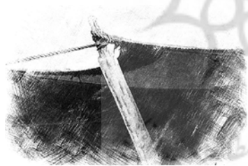
شکل ۵. جزئیات قرارگیری ستون مورب سیاه‌چادر
