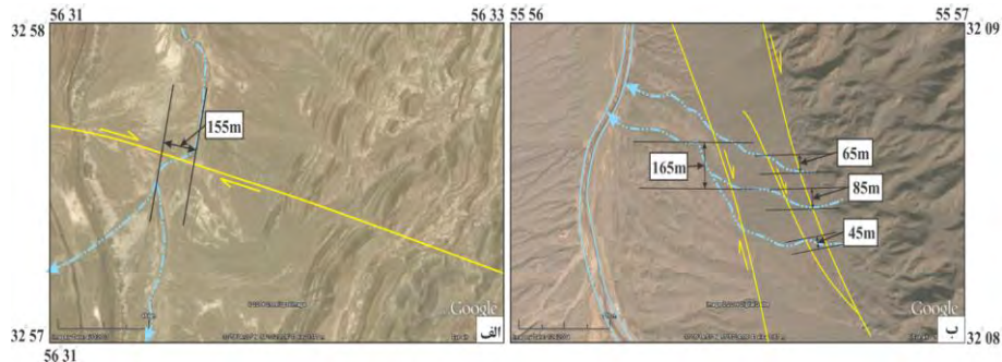
شکل (۱۱). (الف) محل تقاطع گسل با آبراهه ها و جابجایی راستگرد آن ها در بخش غربی منطقه و (ب) جابجایی راستگرد آبراهه در بخش شرقی منطقه.
