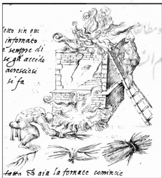
شکل ۱: طراحی پیکولپاسو، کوره چوب‌سوز در حال احیاء (رادز، ۱۳۸۲، ص. ۶۰)
