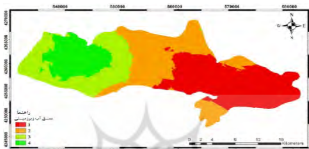
شکل (۴) نقشه پهنه‌بندی عمق آب زیرزمینی با استفاده از مدل دراستیک
