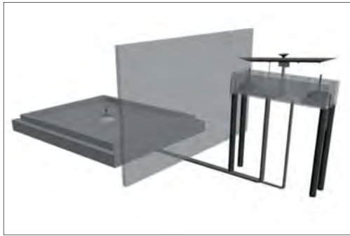
شکل (۱۲) - تصویر بازسازی شده فواره دوم تقی‌الدین با سیستم کنترل شناور - فوران خیمه
