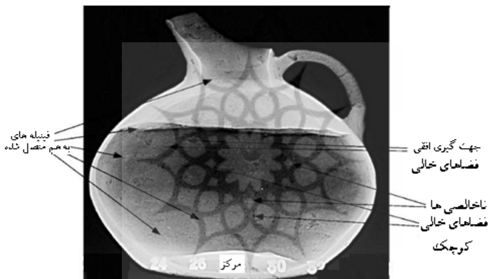
تصویر ۸. قرارگیری افقی فضاهای خالی و ناخالصی‌ها در تصویر رادیوگراف ظرف ساخته شده به روش فیئبله‌ای. (Ambers & Jones, 2009, plate9)
