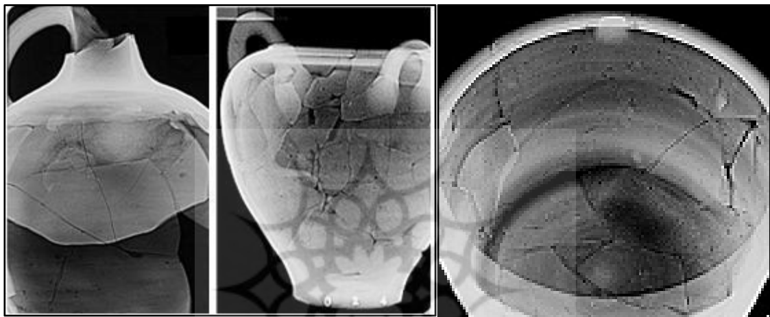
تصویر ۲. نمایان شدن انواع ترک‌ها و شکستگی‌ها (قابل مشاهده یا غیرقابل مشاهده باچشم) در اشیای سفالی با استفاده از تصویر پرتونگار (Ambers & Jones, 2009, plate 21, 22&13).
